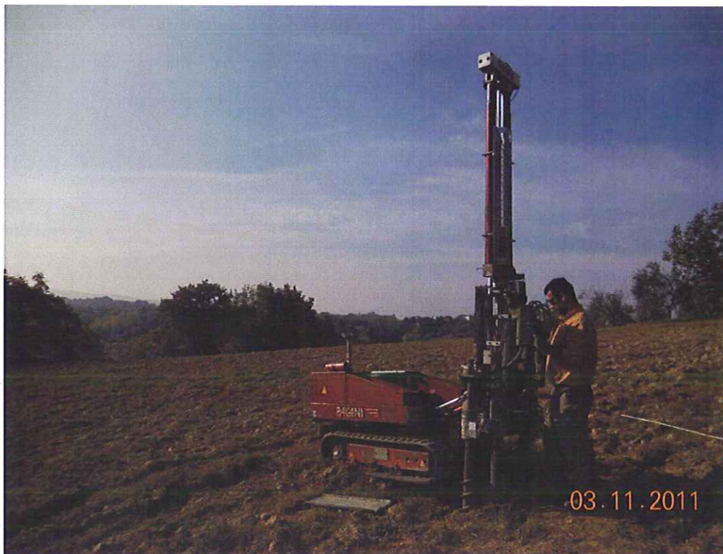
Figura 1: Prova penetrometrica CPT1
