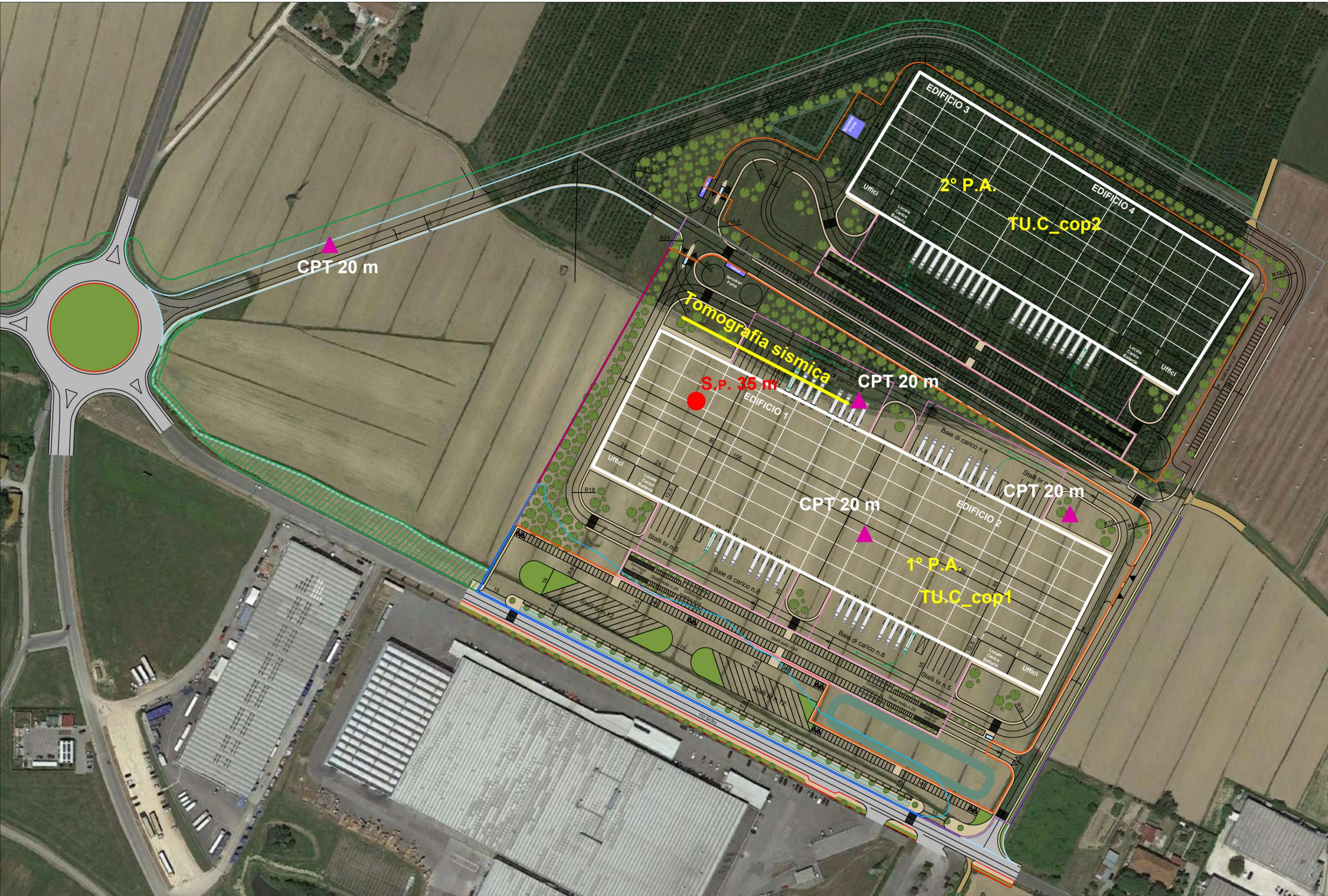
FIGURA 13: Planimetria generale con ubicazione nuove indagini geognostiche e sismiche (scala 1:2000)
