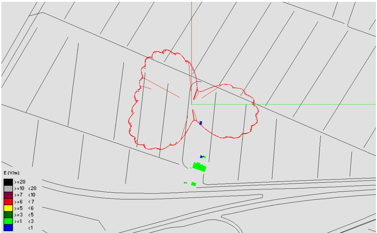
Fig. 3 Impatto elettromagnetico - Zona Area Lavaiano c/o impianto esistente - Vista dall'alto
