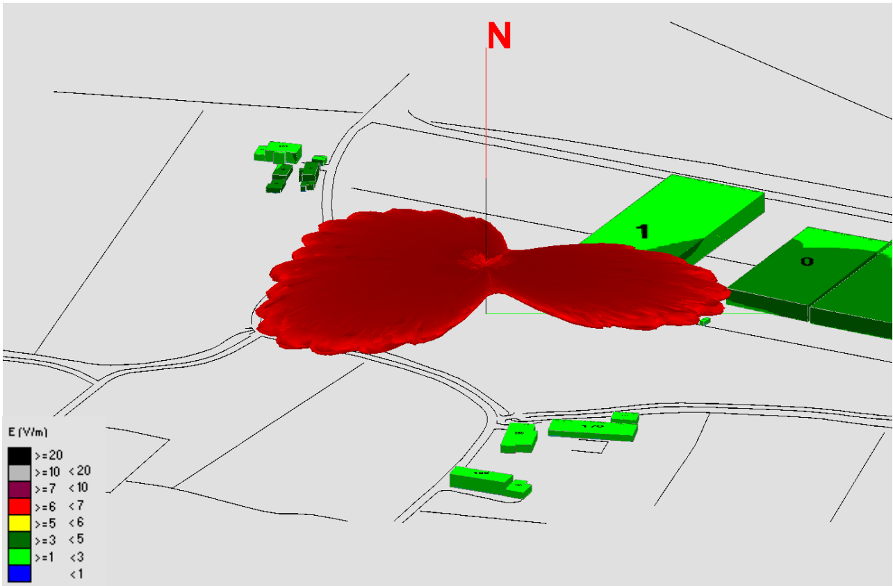
Fig. 17 Impatto elettromagnetico - Zona Parcheggio Via Melorie - 0°/Nord
