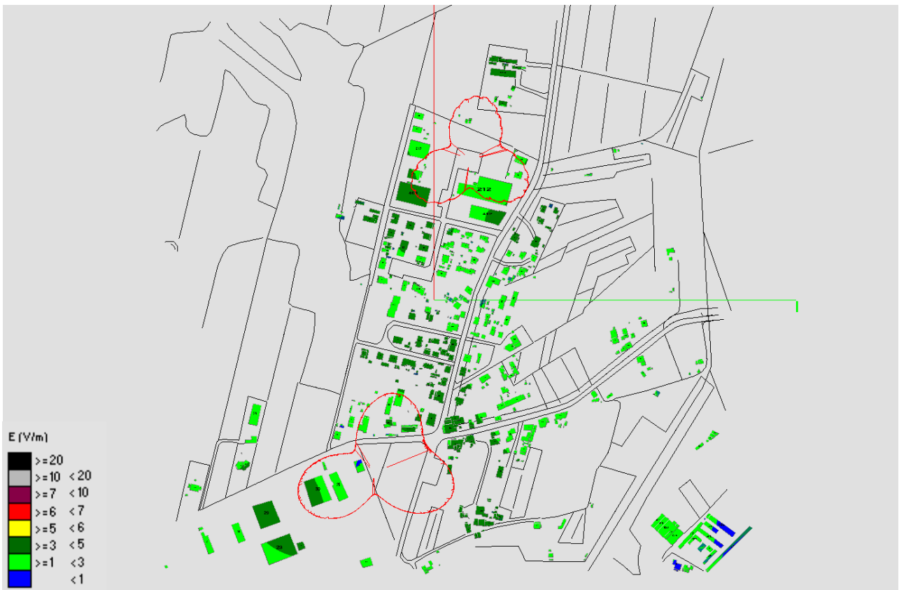
Fig. 8 Impatto elettromagnetico-Zona Via Livornese Ovest Confine con Crespina Lorenzana-Vista dall'alto
