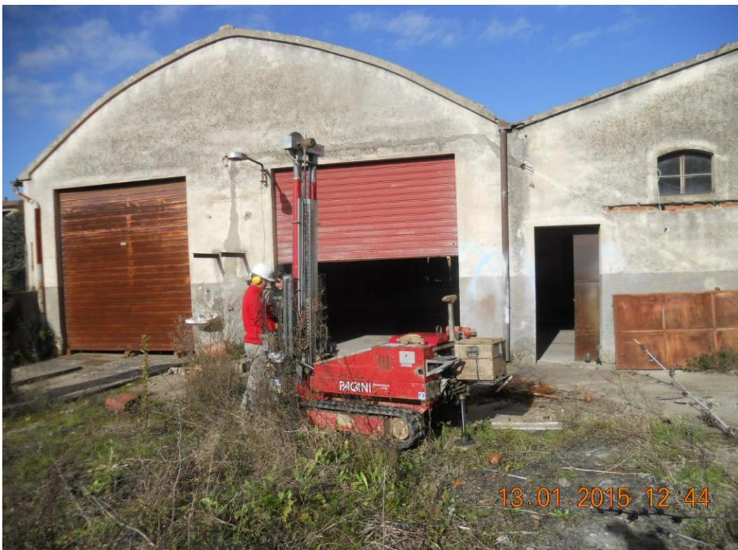
Figura 2: Prova penetrometrica DPSH2
