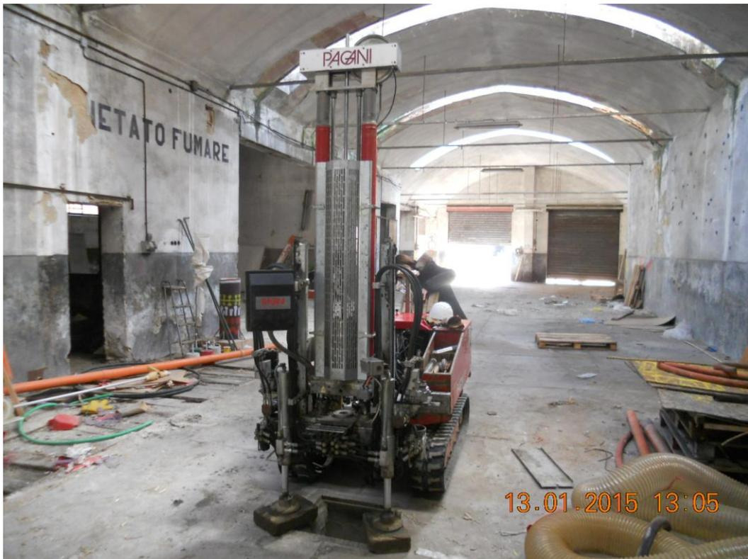
Figura 3: Prova penetrometrica DPSH3
