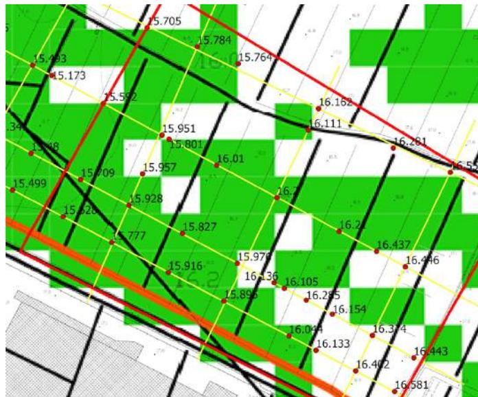
A seguito dello studio di dettaglio condotto dall'Ing. Croce risulta che il battente medio è pari a 0.30 m.
