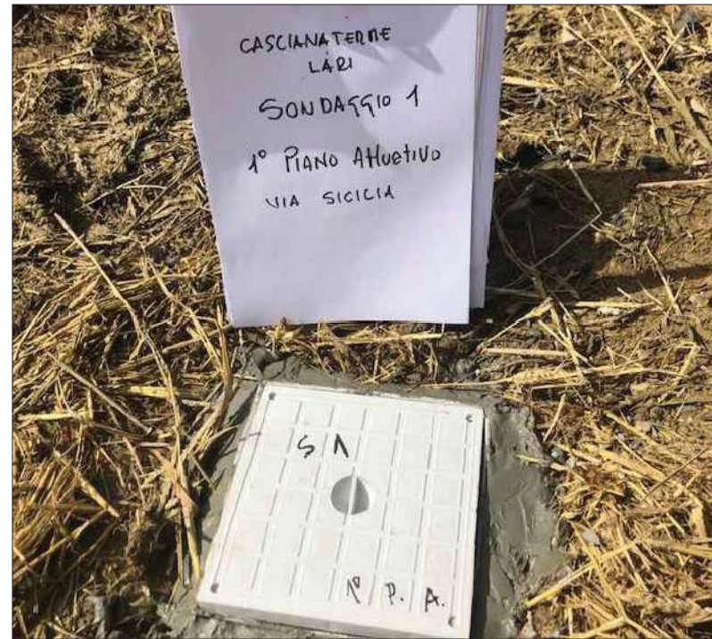
Foto pozzetto protezione
