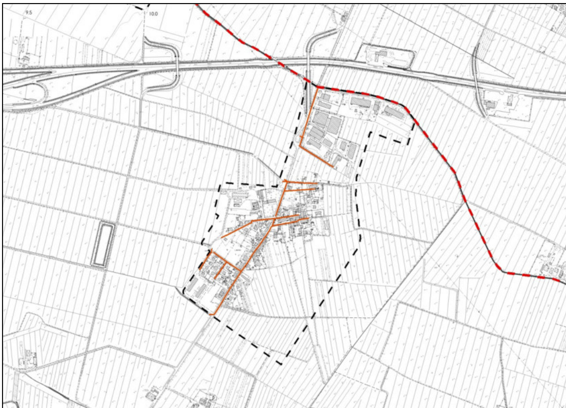
Fig. 36: Copertura della fognature nel centro abitato di Lavaiano
