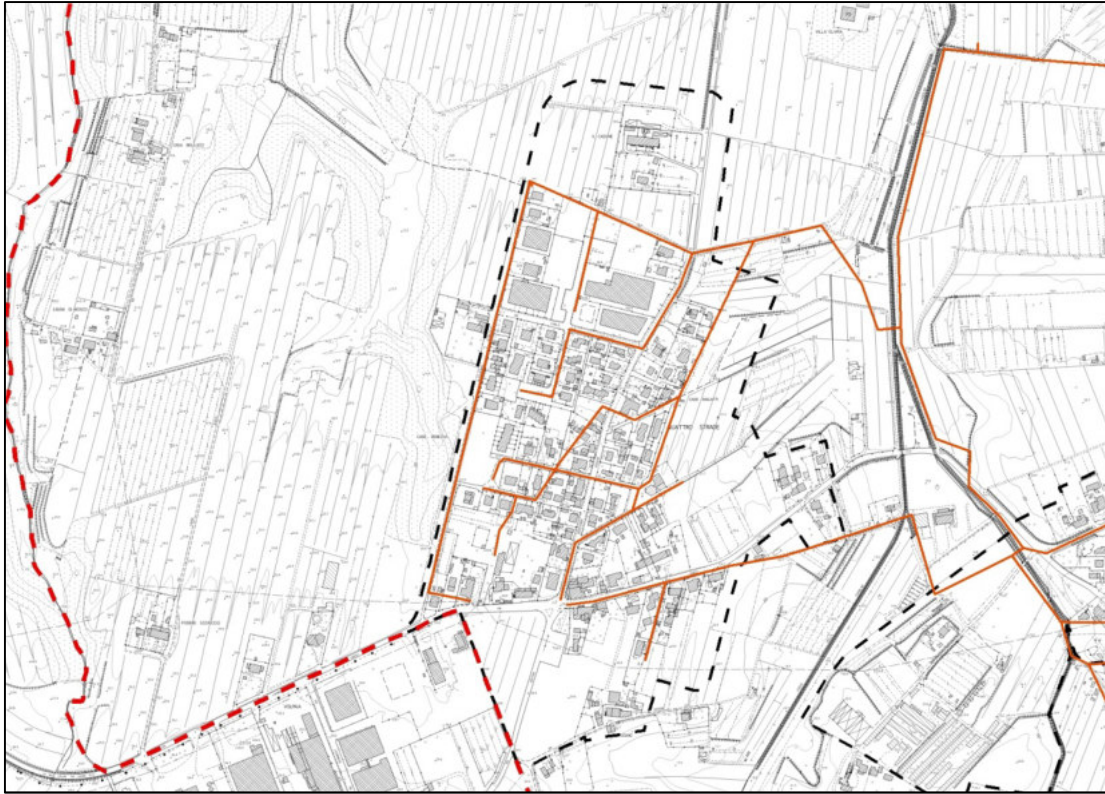
Fig. 35: Copertura della fognature nel centro abitato di Quattro Strade
