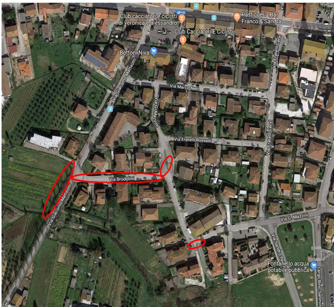
La fognatura esistente è posta ad una quota tale che non consente, in caso di consistenti precipitazioni, lo smaltimento completo delle acque: in particolare il punto di immissione sul fosso Petagnoli, posto a monte del ponte di via Matteotti, manufatto che produce un restringimento dell'alveo del canale, è ad una quota quasi prossima al pelo libero dell'acqua.
