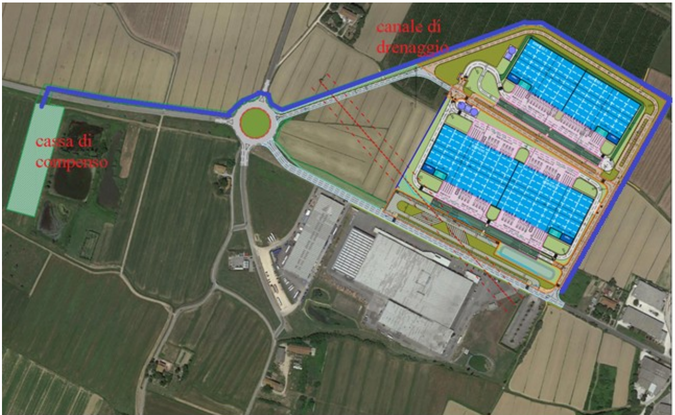
Fig. 4.1 – Opere di drenaggio per i Comparti 7 e 8.
