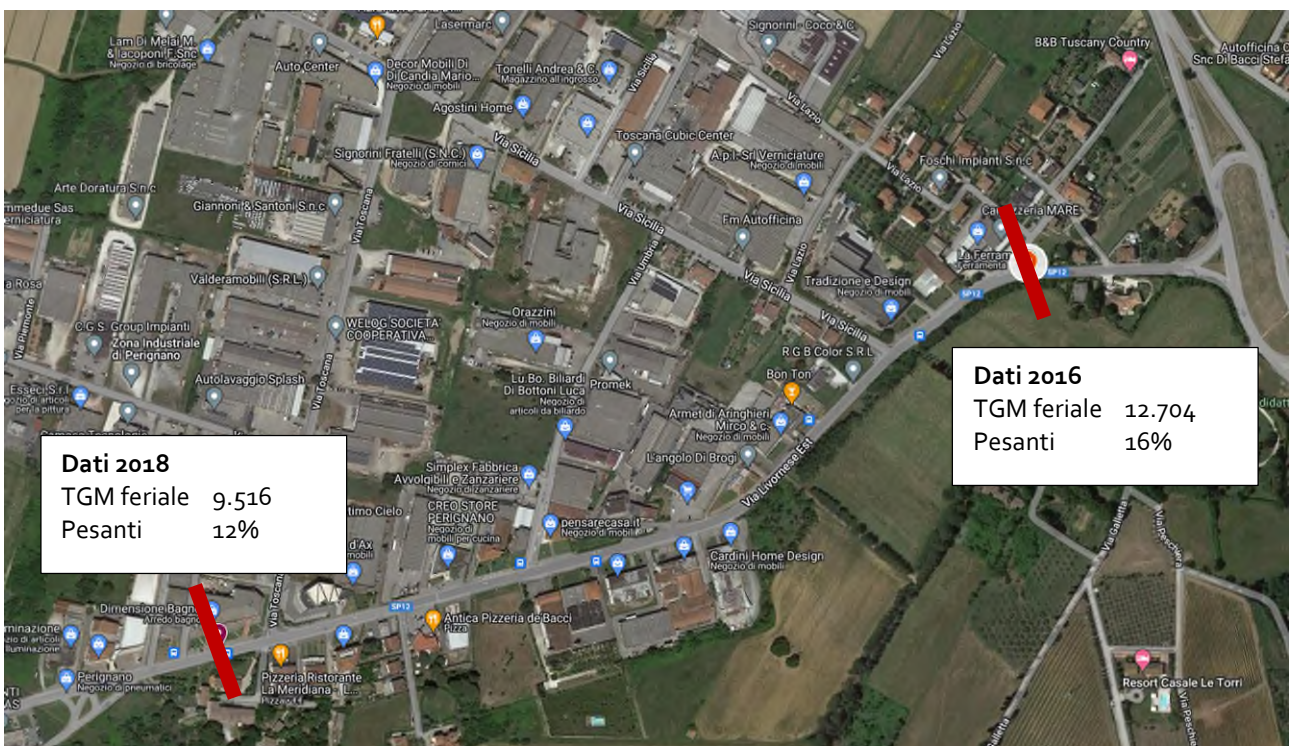
Figura 46 – Postazioni di rilievo del traffico della Provincia di Pisa lungo la SP12
