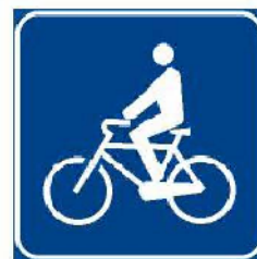
Fig 2: Attraversamento ciclabile. (fig II 324 art 135, DPR 495/92)
