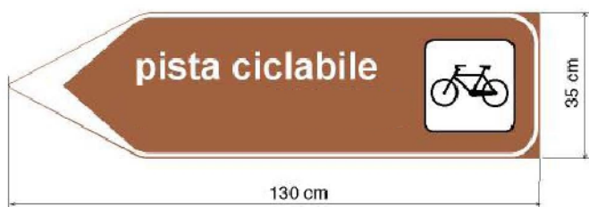
Fig 1: Segnale di direzione (avviamento) a itinerario ciclopedonale dai segnali turistici per strade extraurbane (fig. II 294b art 134, tabella II 14a DPR 495/92)
